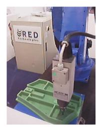
L'impianto robotizzato è programmabile come un classico centro di lavoro. Tramite un sistema CAD / CAM si esegue la modellazione 3D del pezzo e la generazione del programma di lavoro. Questi viene poi importato nell'ambiente di simulazione 3D, per la verifica e la traduzione in linguaggio robot. Si riducono i fermo macchina: la programmazione viene effettuata mentre la macchina è produttiva.
